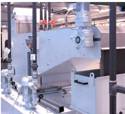
Bandfilteranlage mit Reintank und integrierten Pumpensystemen. Belt filter system with clean tank and integrated pump systems.
