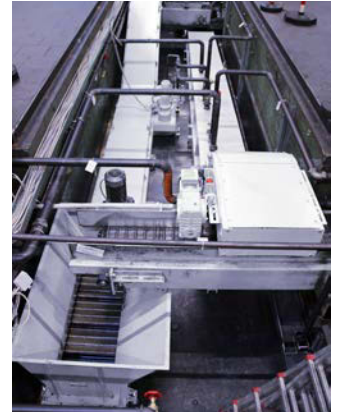
Kratzbandförderer mit Hebestation (links im Bild). Scraper conveyor with lifting station (left in the picture).
