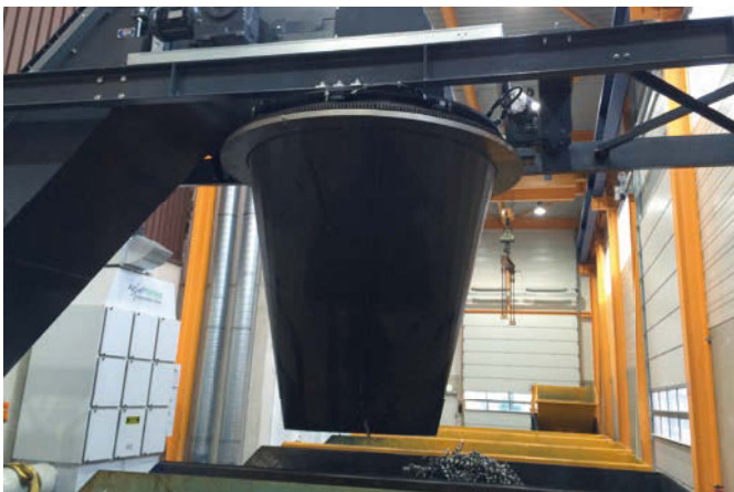
Optimierung des Füllgrades durch schwenkbare Rutsche. Optimization of the fill level by pivoting chute.
